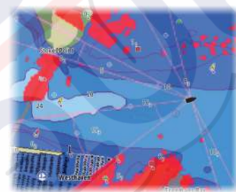
Superposition du radar sur une carte
